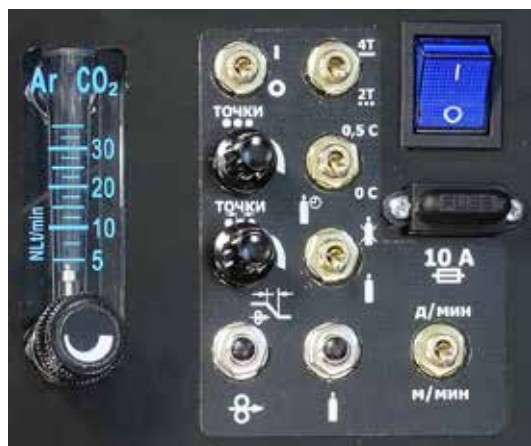
внутренняя панель управления ПДГО-512 УРАЛ
