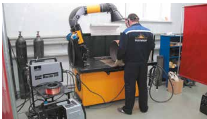
Испытания полуавтоматов на сварочные свойства
