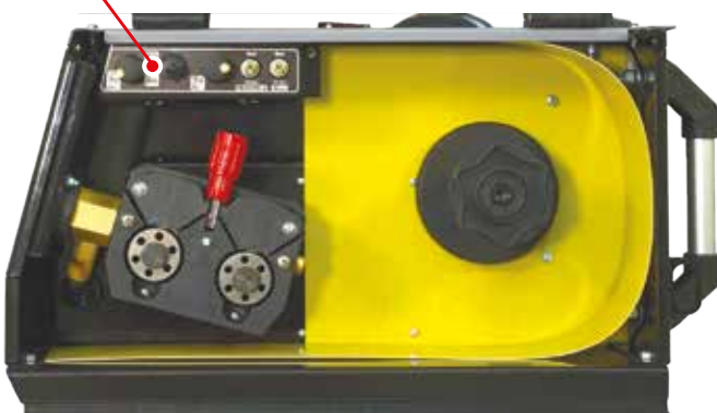
Панель управления внутреннего отсека
