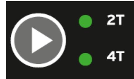
Кнопка выбора режима тактности работы кнопки горелки:
