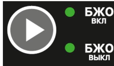
Кнопка **включения/выключения блока жидкостного охлаждения**. Функция необходима для быстрой переналадки оборудования для применения горелок с газо-воздушным или жидкостным охлаждением
