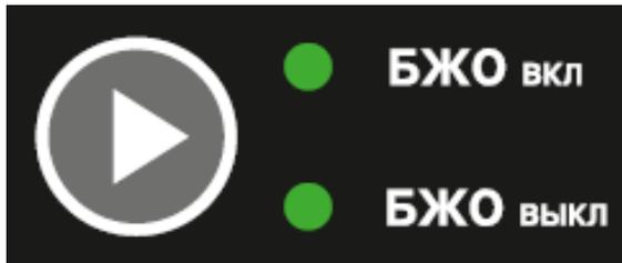
Кнопка включения/выключения блока жидкостного охлаждения. Функция необходима для быстрой переналадки оборудования для применения горелок с газо-воздушным или жидкостным охлаждением
