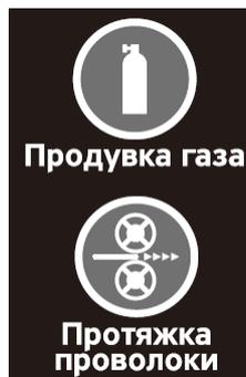
Кнопка **продувки защитного газа без сварки**. Используется для проверки и регулировки на регуляторе газового редуктора потока защитного газа до начала сварочного процесса.
