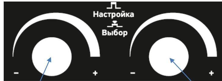
**Энкодер** настройки сварочного напряжения и других параметров. Нажатием на энкодер осуществляется переключение между параметрами, вращением энкодера осуществляется настройка параметров
