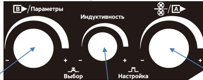
Энкодер настройки сварочного напряжения и других параметров
