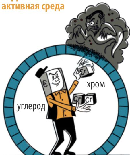
В интервале температур +450°C, +850°C по границам зерен аустенита выпадают карбиды хрома, в результате наружные слои аустенитного зерна теряют стойкость против коррозии.
